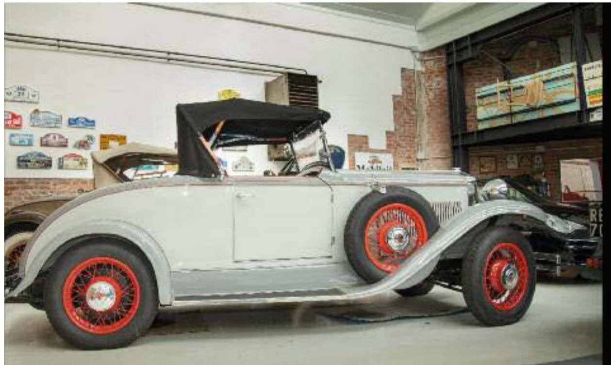
La Fiat 521 è un modello di automobile prodotta dalla Fiat dal 1928 al 1931, con struttura in acciaio. Direttamente derivata dal modello "520", ne conservò molte caratteristiche costruttive, limitando le innovazioni a carrozzerie, dotazioni e colori. Era equipaggiata con un propulsore di sei cilindri in linea, raffreddato ad acqua, e veniva fornita con autotelaio con passo corto o lungo, quest'ultimo di 3.140 mm. Il motore esacilindrico, di 2.516 cm<sup>3</sup> eroga 51 CV a 3.400 giri/minuto.
